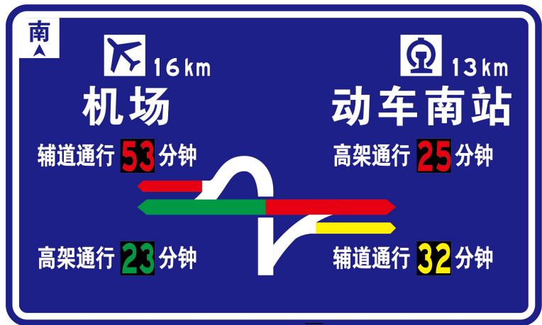
图C 具备路况—行程时间信息动态发布功能的局部可变信息标志
