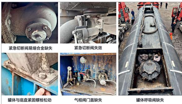
紧急切断阀易熔合金缺失
