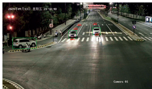
图1 目标静止后引发的雷达误检示例
